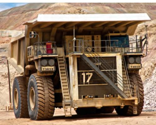
La mina de cobre Ray de la empresa ASARCO opera una flota de 39 equipos de carga. De los cuales 21 son Liebherr T282S. Estos son equipos de gran clase con una capacidad de carga de 400 toneladas y cada uno con un motor de 3,600 caballos de fuerza, los cuales operan en condiciones muy severas en el suroeste de los Estados Unidos.
